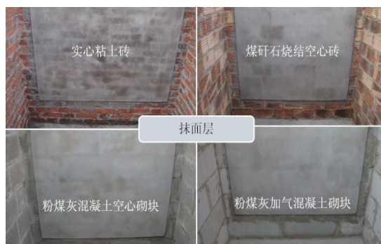
建筑砌块实验
